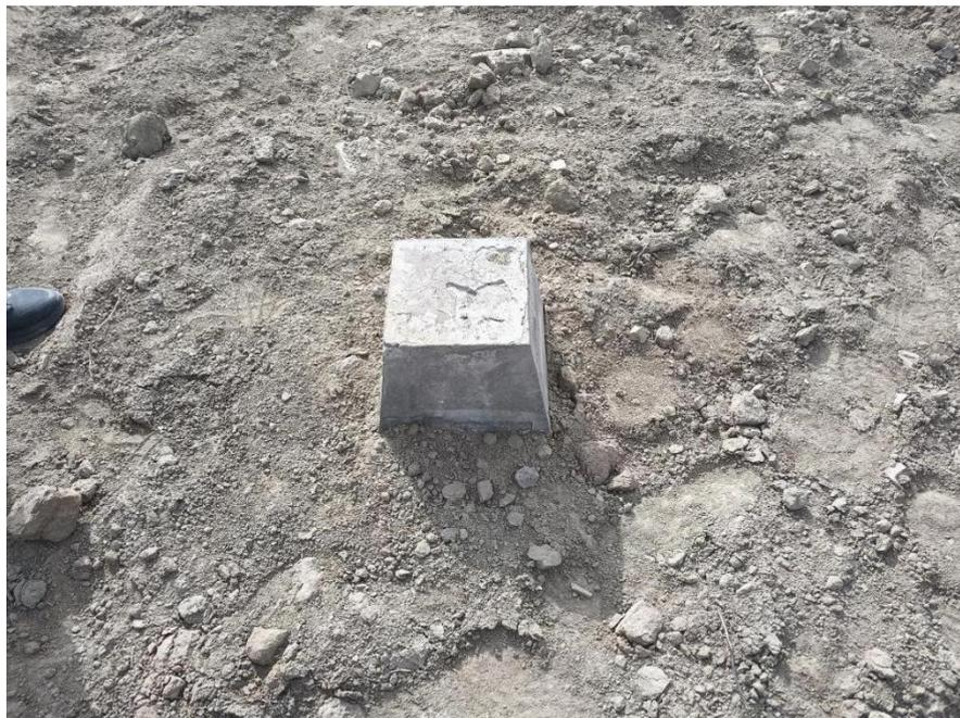
图 2-13 位移观测点
