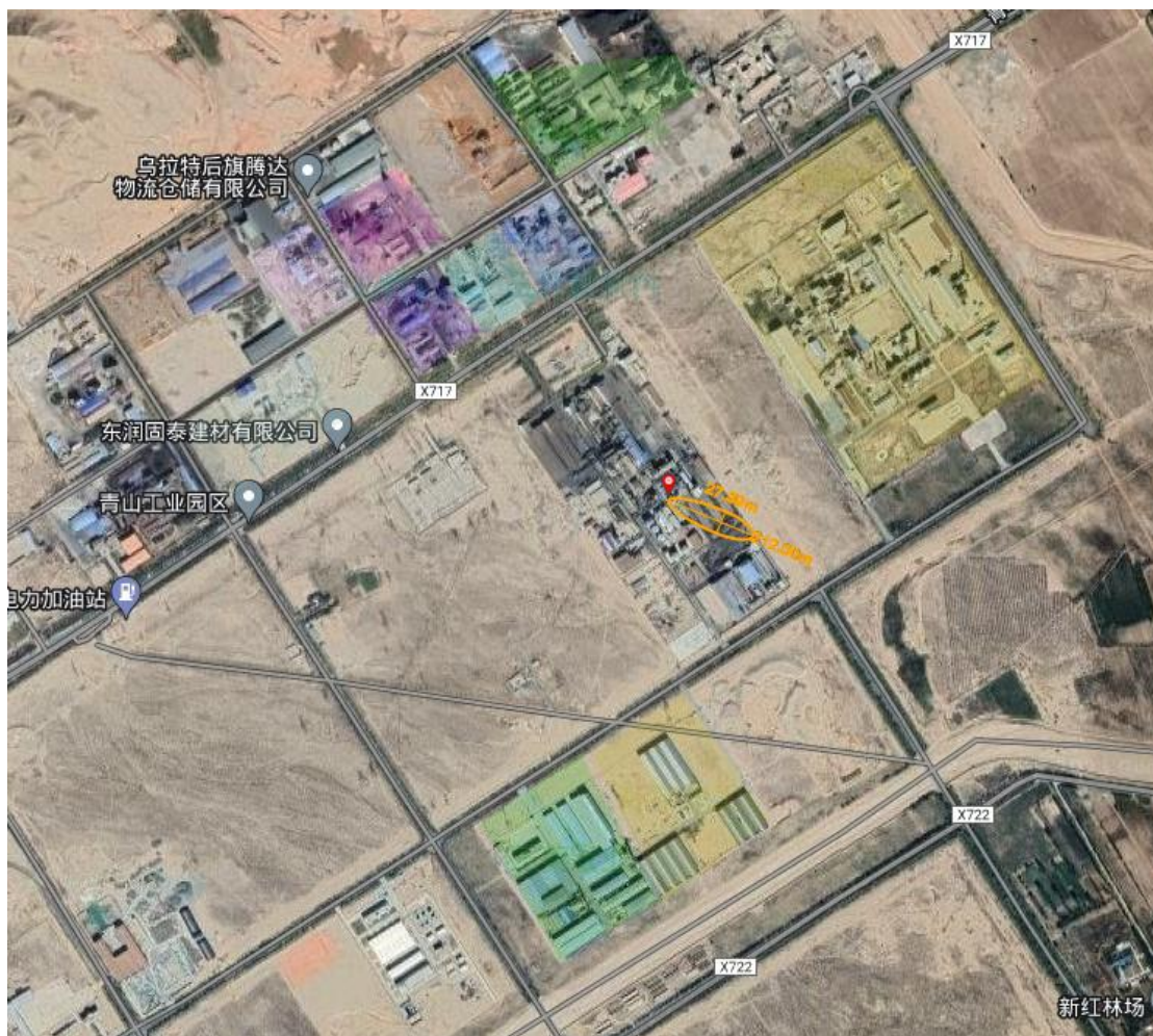
附图 D. 2. 2-2 二氧化硫管道发生有毒有害物质泄漏扩散事故伤害范围模拟图
