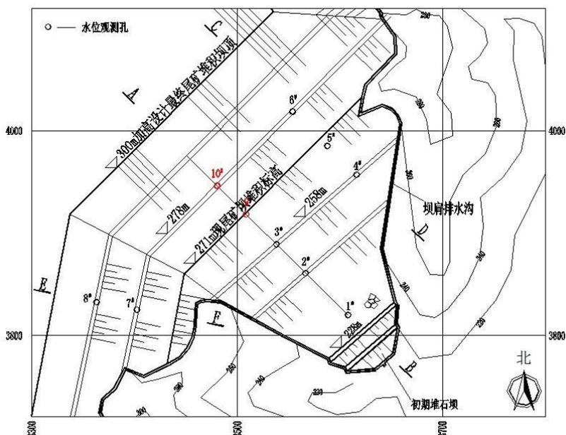
图 2.4-17 水位观测孔布置图
