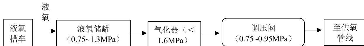
图 2.3-6 氧[液化的]供应工艺流程简图
