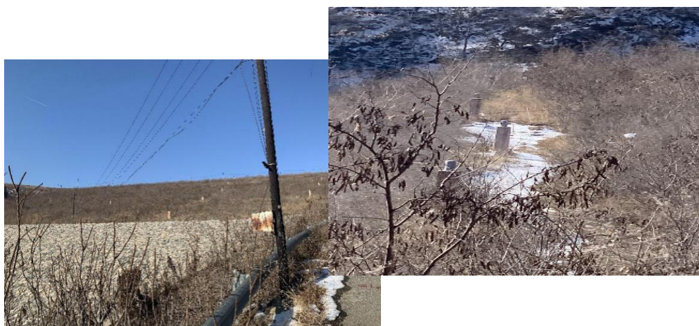
图 2.4-8 棱镜式坝体位移观测桩
