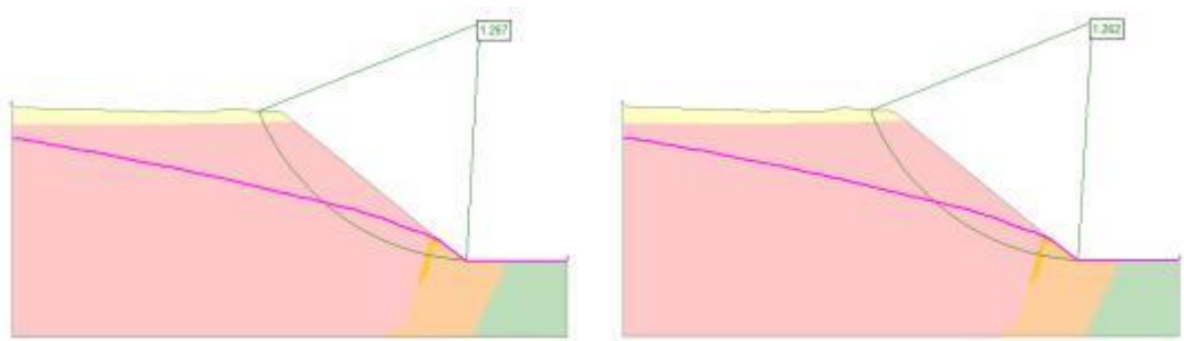
(a) 简化Bishop 法 (b) M-P 法 3.2.2-7 II-1 剖面荷载组合 I 工况分析结果
